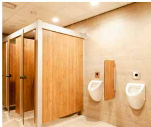
La séparation d'urinoir Afkor Type U est un concept innovant qui comprend un profil vertical en aluminium extrudé. La fixation invisible se fait directement dans le mur par vis et chevilles. Le panneau décoratif en stratifié haute pression, épaisseur de panneau 13 mm, est pincé dans le profil aluminium vertical. Les fixations invisibles, à la fois du profil aluminium et du panneau assurent un concept robuste qui est très facile à entretenir.
